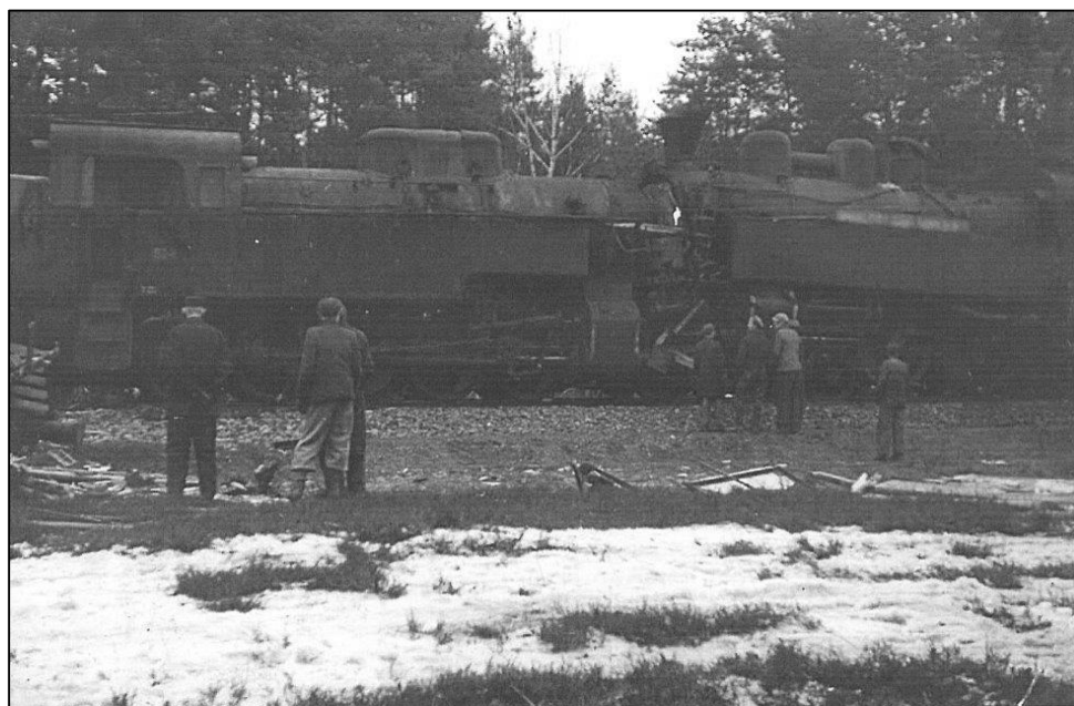
Zaklíněné parní stroje po nárazu. Vlevo lokomotiva č. 524.172 manipulačního vlaku jedoucího od Borohrádku, vpravo lokomotiva č. 354.172 spěšného vlaku jedoucího od Čermné n.Orlicí.
